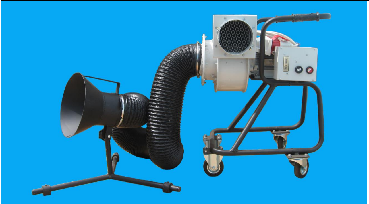
Внешний вид универсальной передвижной вентиляционной установки «УПВУ-1300-3»
