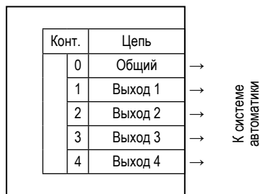
схема подключения выходов с нормально замкнутым (НЗ) или нормально разомкнутым (НР) состоянием
